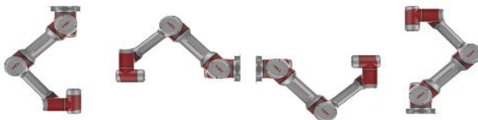
図 3-5 典型的な据え付け方式
