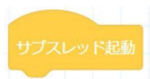
**説明:** プログラムのサブスレッドの識別子です。サブスレッドはメインスレッドと同時に実行されますが、サブスレッドはロボット制御コマンドを使用できず、変数演算またはIO制御のみを実行することができます。プロジェクトロジックに応じてサブスレッドを使用するかどうかを選択してください。
