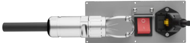
図 6-21 ロボットケーブルをコントローラに接続する
