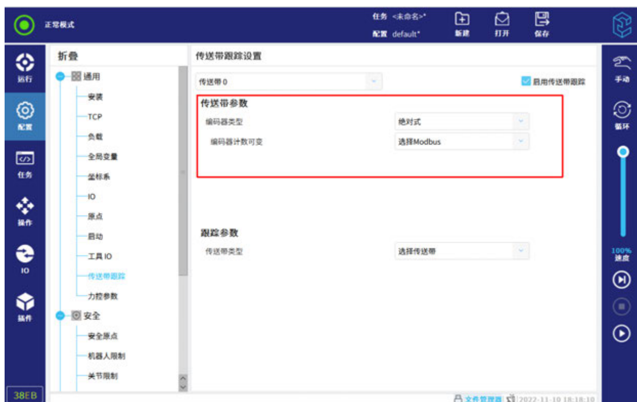
図 12-33 コンベアパラメータの設定
