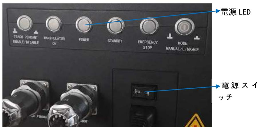
図 9-1 コントロールボックス電源スイッチ及びランプの概略図
