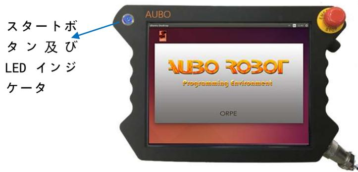
図 9-2 ティーチペンダント起動ボタン及び LED オンランプの概略図
