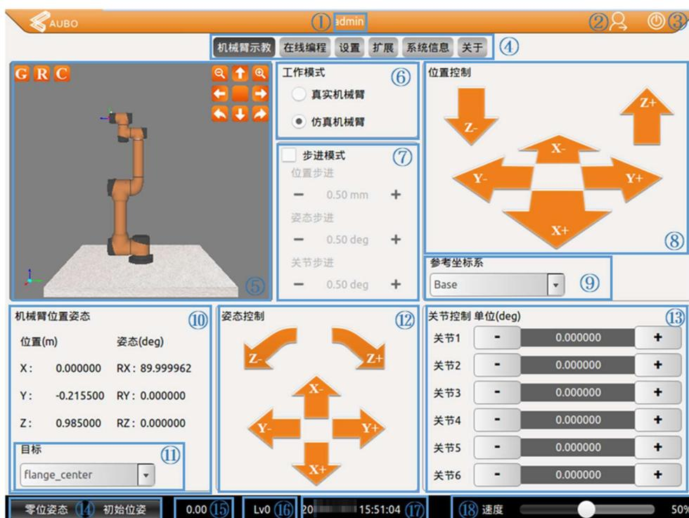
図 10-4 ロボット教示パネル概略図
