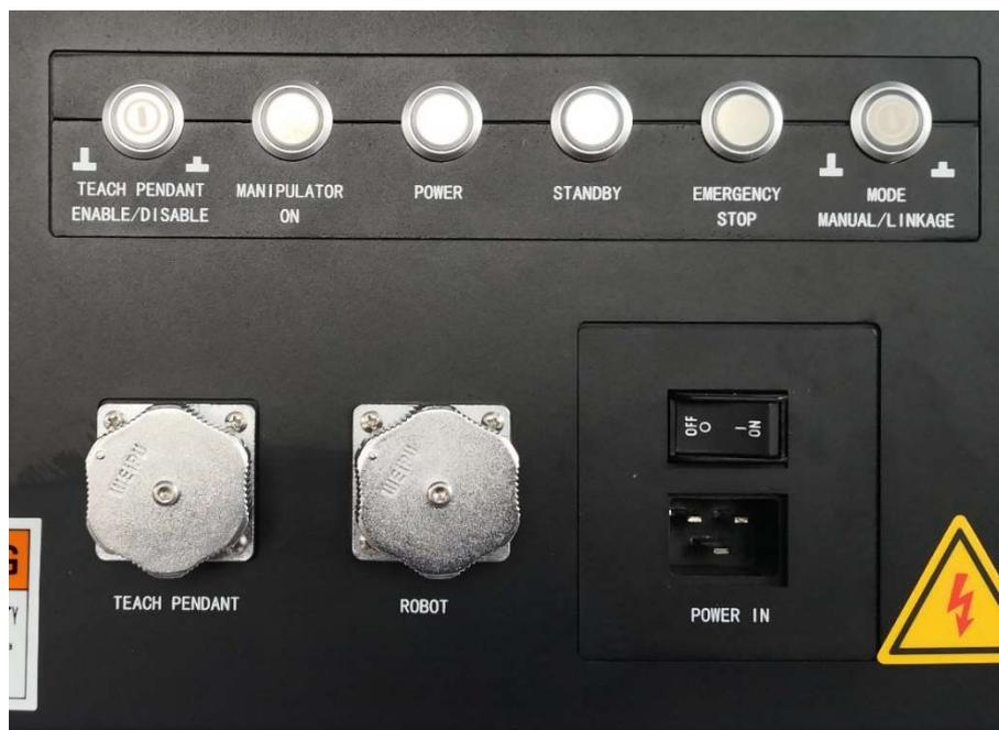
図 7-2 コントロールボックス前面パネル概略図
